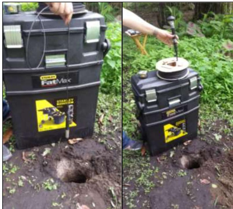
**Figura 25. Colocación de los Dispositivos que se Utilizaron para la Medición del Nivel del Agua en las Pruebas de Infiltración.**
